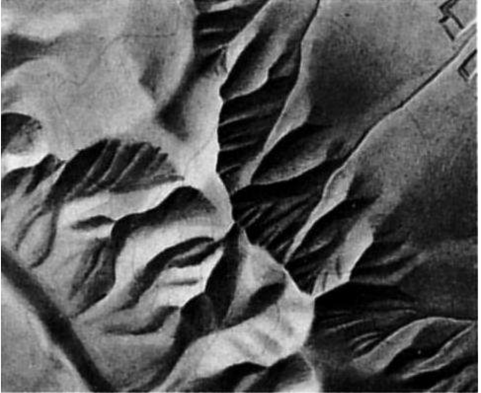
Figura 80: Umbrire produsă grafic după principiul iluminării locale; iluminare principală nord-vestică. Sursă: Eduard Imhof, Cartographic Relief Presentation
