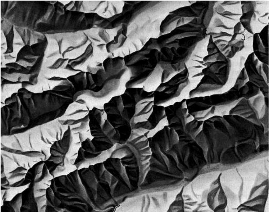
Figura 82: Iluminare oblică ajustată după principiul perspectivei atmosferice (în munții Alpi). Sursă: Eduard Imhof, Cartographic Relief Presentation.
